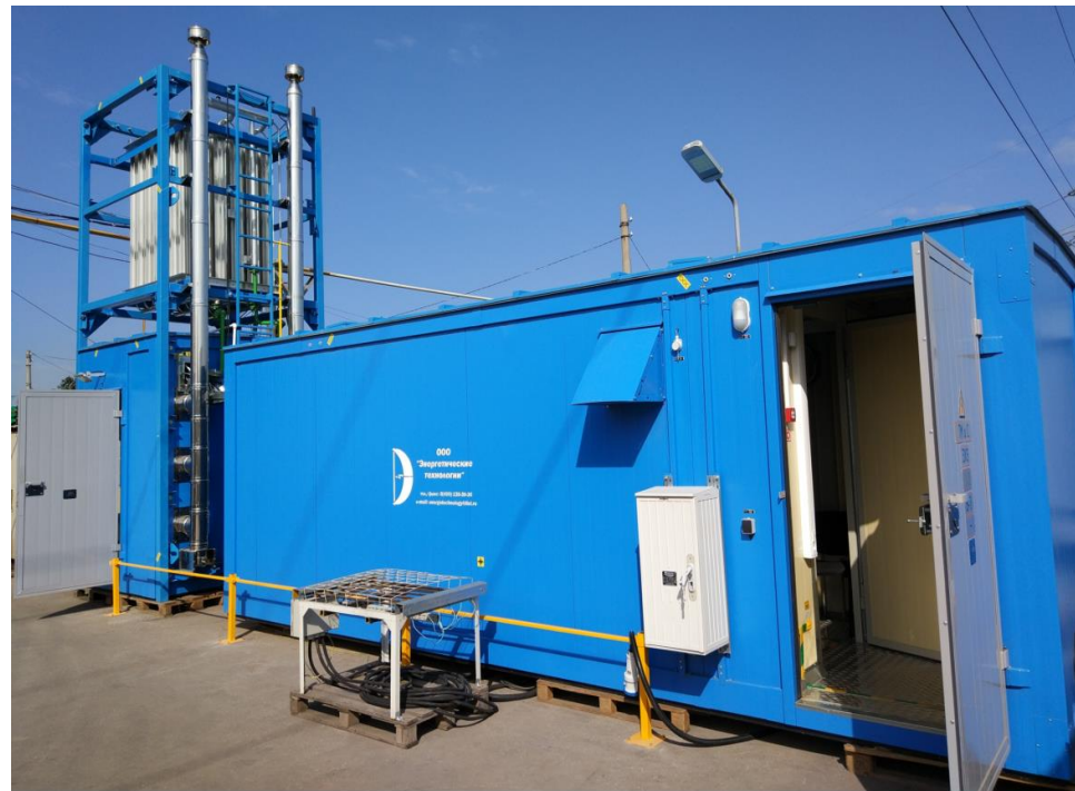
Многосовдвигательный источник в комплексе с технологическим контейнером для объекта ПРС (изготавливается совместно с партнерской организацией)
