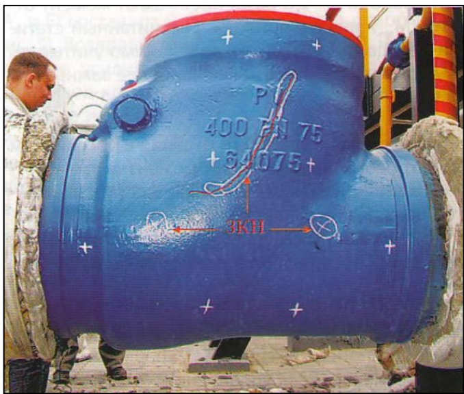
Результаты контроля затвора обратного методом магнитной памяти металла
