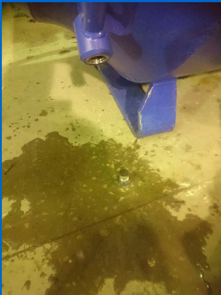
Вода в системе смазки. В 3х из 8ми доставленных на переконсервацию.
