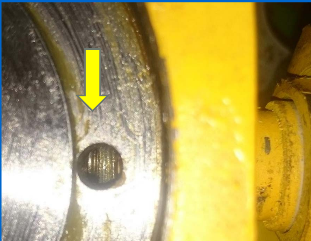
Ду150-300. Перекрыт канал подачи газа штуцером. 8 шт. крышек пневмогидроцилиндра.
