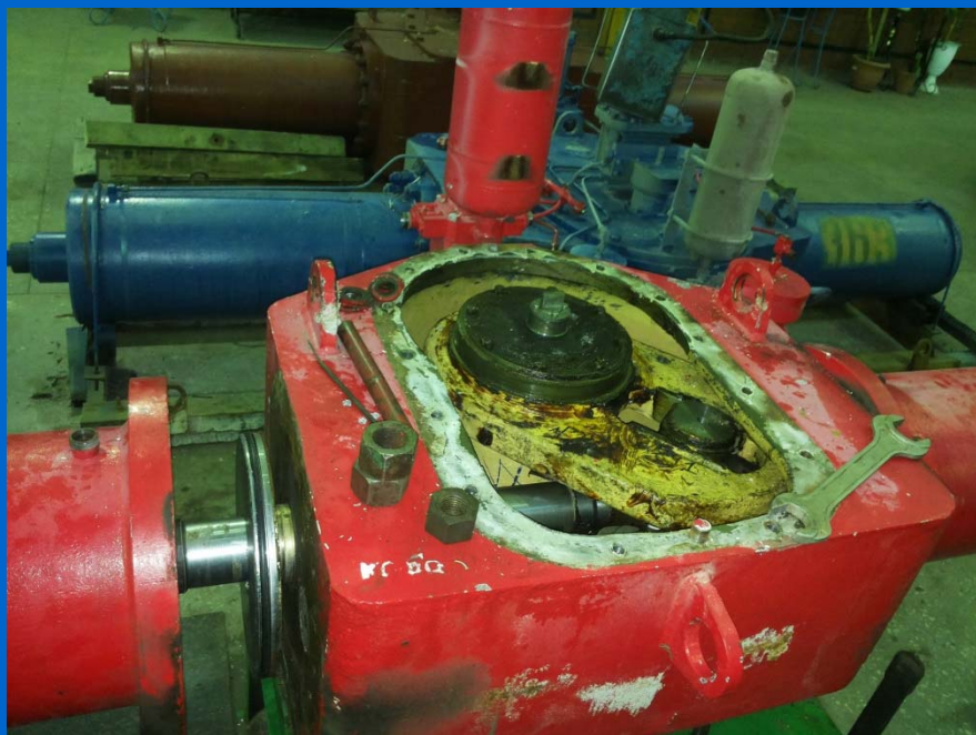
Отсутствие технологических лючков
