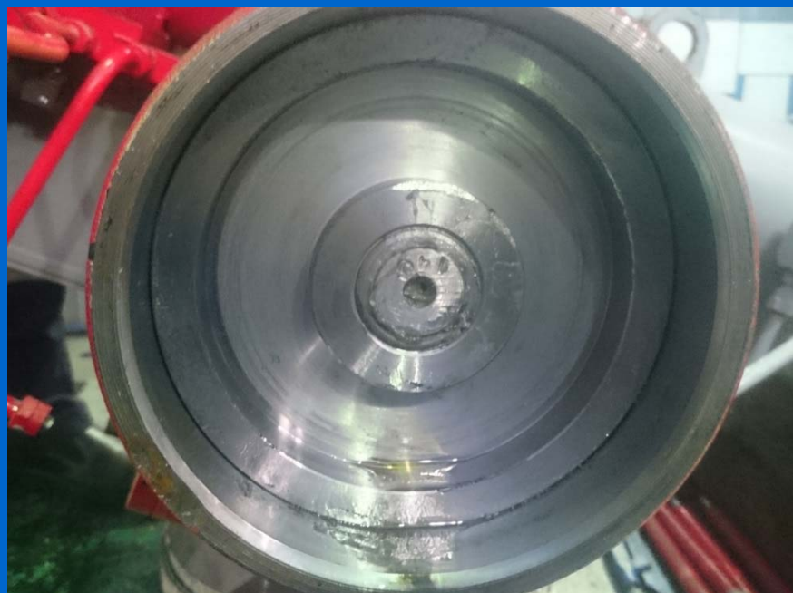
Отсутствие фиксации резьбового соединения
