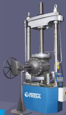
9 ИСПЫТАНИЕ АРМАТУРЫ НА ПРОЧНОСТЬ, ПЛОТНОСТЬ МАТЕРИАЛА КОРПУСА И ГЕРМЕТИЧНОСТЬ ЗАТВОРА
