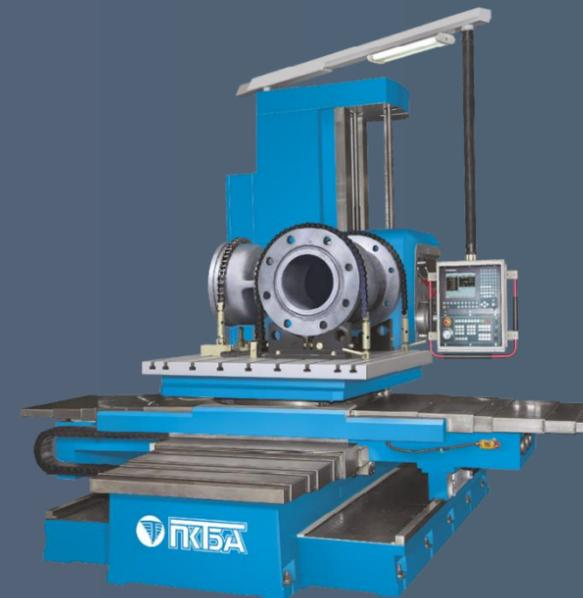
6 МЕХАНИЧЕСКАЯ ОБРАБОТКА УПЛОТНИТЕЛЬНЫХ ПОВЕРХНОСТЕЙ
