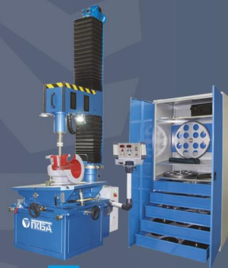
7 ШЛИФОВАНИЕ И ПРИТИРКА УПЛОТНИТЕЛЬНЫХ ПОВЕРХНОСТЕЙ
