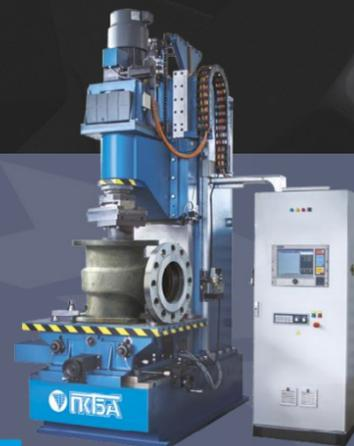
4 МЕХАНИЧЕСКАЯ ОБРАБОТКА УПЛОТНИТЕЛЬНЫХ ПОВЕРХНОСТЕЙ
