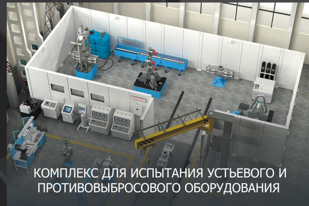
КОМПЛЕКС ДЛЯ ИСПЫТАНИЯ УСТЬЕВОГО И ПРОТИВОВЫБРОСОВОГО ОБОРУДОВАНИЯ
