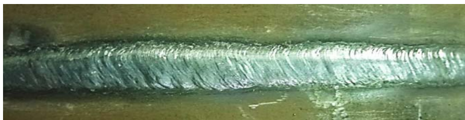
А) Внешний вид сварного шва выполненного постоянным током обратной полярности, размагниченная труба (величина индукции 0 Гс)
