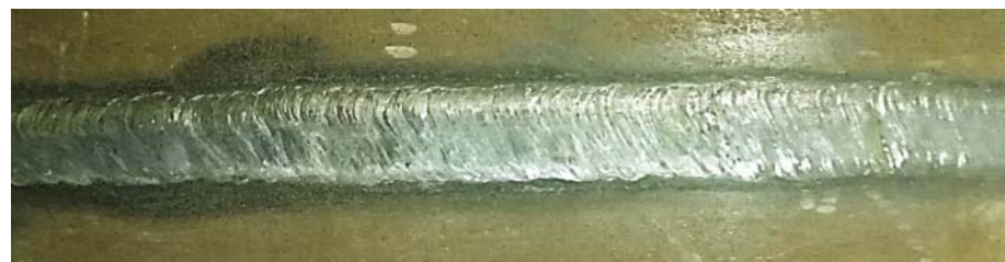
Б) Внешний вид сварного шва выполненного амплитудной модуляцией разнополярных прямоугольных импульсов тока, намагниченная труба (начальная величина индукции 1000 Гс)
