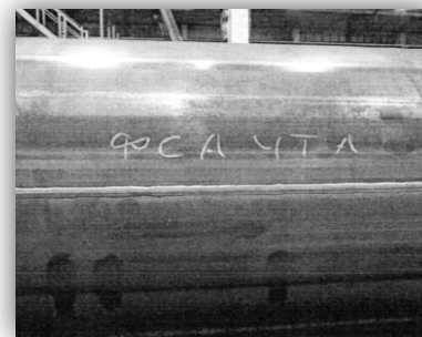
Многодуговая сварка продольных (заводских) швов труб (АО «ВТЗ», флюс ФСА ЧТ А 650-20/80)
