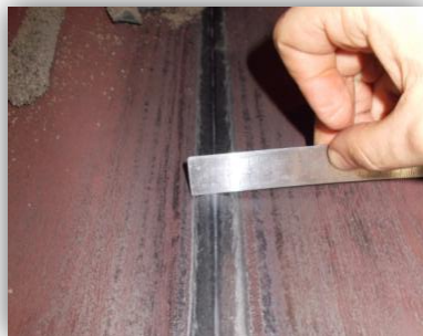
Многодуговая сварка продольных (заводских) швов труб (ЗАО «ИТЗ», флюс ФСА ЧТ А 650-20/80)
