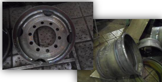
Сварка колесных дисков (ПАО «ЧКПЗ», флюс UF-02, UF-03)
