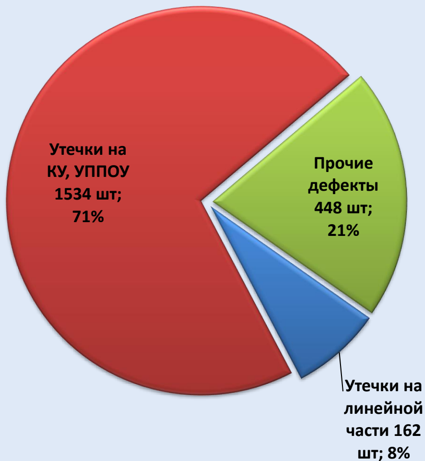
Дефекты, обнаруженные при приборном обследовании
