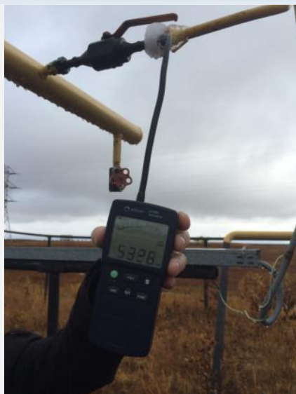
Негерметичность корпуса ТПА/ утечка по фланцам
