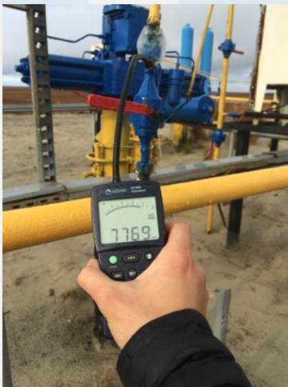
Негерметичность системы импульсного газа
