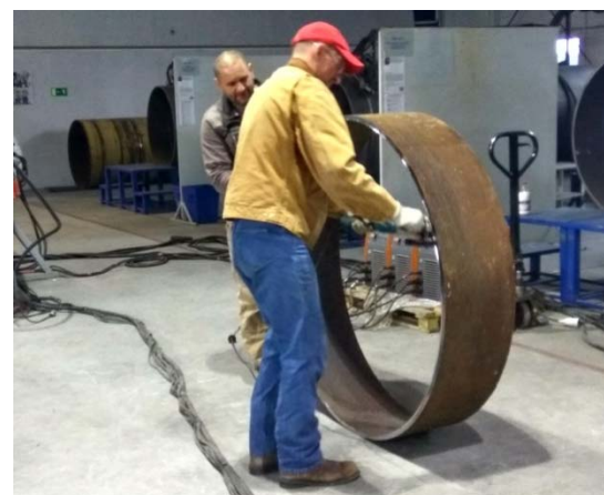
Подготовка катушек к сборке КСС Ø1420×21,7 мм, К60
