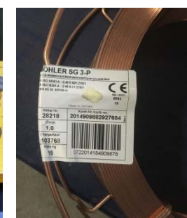
Сварочная проволока сплошного сечения марок TS-6 (Ø0,9 мм), K-600 (Ø1,0 мм) и SG3-P (Ø1,0 мм) производства компании «voestalpine Boehler Welding Germany GmbH» в катушках типа SD100 весом 1,5 кг для корневого слоя и типа К-300 весом 15 кг для горячего прохода, заполняющих и облицовочных слоев шва.
