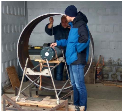
Радиографический контроль КСС рентгеновским аппаратом ICM Site-X300
