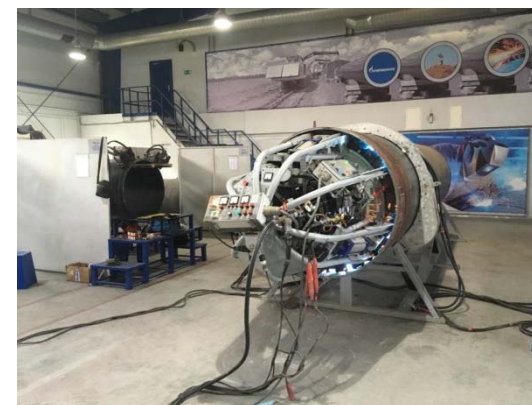
Сварка корневого слоя шва проволокой сплошного сечения в защитной смеси 82%Ar/18%CO 2
