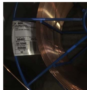
Сварочная проволока сплошного сечения марок TS-6 (Ø0,9 мм), K-600 (Ø1,0 мм) и SG3-P (Ø1,0 мм) производства компании «voestalpine Boehler Welding Germany GmbH» в катушках типа SD100 весом 1,5 кг для корневого слоя и типа К-300 весом 15 кг для горячего прохода, заполняющих и облицовочных слоев шва.
