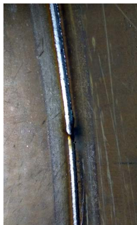
Корневой слой шва в положениях 8 и 2 часа. ширина 6-8 мм, высота 1,0-1,5 мм
