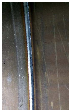
Корневой слой шва в положениях 8 и 2 часа. ширина 6-8 мм, высота 1,0-1,5 мм
