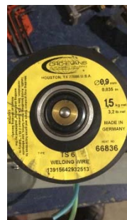
Сварочная проволока сплошного сечения марок TS-6 (Ø0,9 мм), K-600 (Ø1,0 мм) и SG3-P (Ø1,0 мм) производства компании «voestalpine Boehler Welding Germany GmbH» в катушках типа SD100 весом 1,5 кг для корневого слоя и типа К-300 весом 15 кг для горячего прохода, заполняющих и облицовочных слоев шва.
