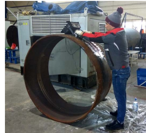
УЗК контроль КСС ультразвуковой измерительной установкой Скаруч серии «Сканер»
