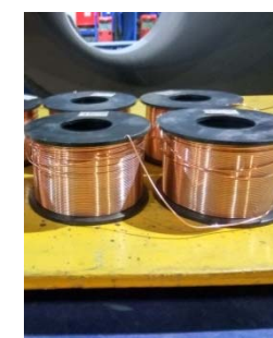
Сварочная проволока сплошного сечения марок TS-6 (Ø0,9 мм), K-600 (Ø1,0 мм) и SG3-P (Ø1,0 мм) производства компании «voestalpine Boehler Welding Germany GmbH» в катушках типа SD100 весом 1,5 кг для корневого слоя и типа К-300 весом 15 кг для горячего прохода, заполняющих и облицовочных слоев шва.
