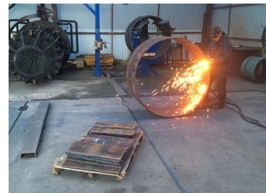
Резка темплетов для механических испытаний
