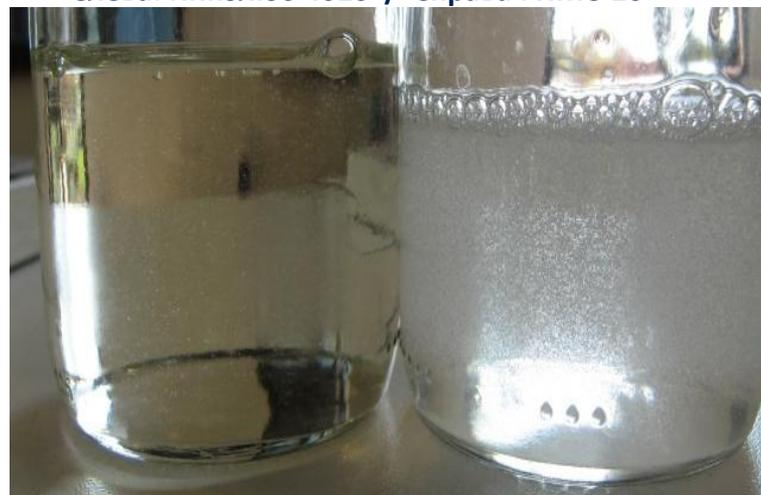
! Плохая деаэрация может повлечь замедленную или неправильную работу клапана.
