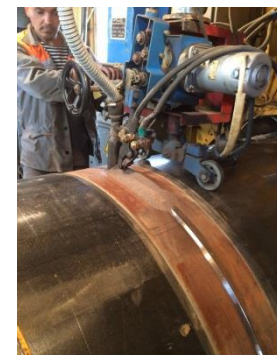
Автоматическая сварка под слоем флюса корневого слоя шва
