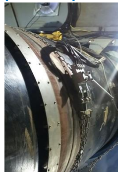
Внешний вид сборки под автоматическую двустороннюю сварку
