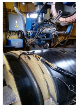
Предварительный подогрев собранного соединения
