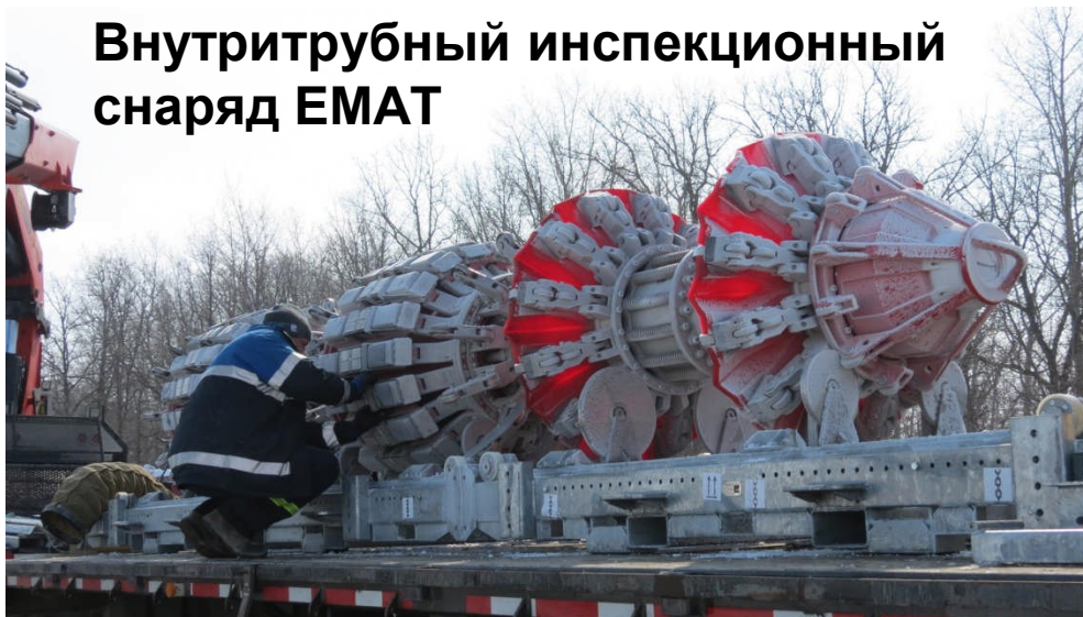
42" внутритрубный инспекционный снаряд ЕМАТ
