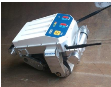
Внутритрубный ультразвуковой сканер-дефектоскоп A 2072 «IntroScan»
