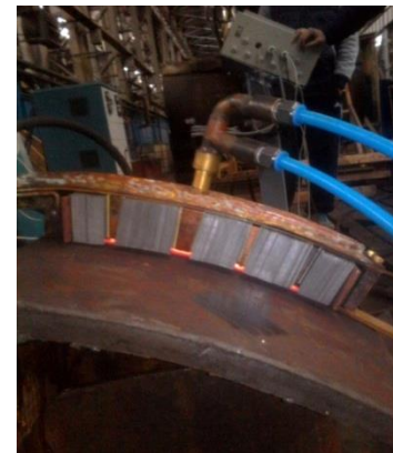
Стенд индукционной термической обработки сварных швов темплетов труб
