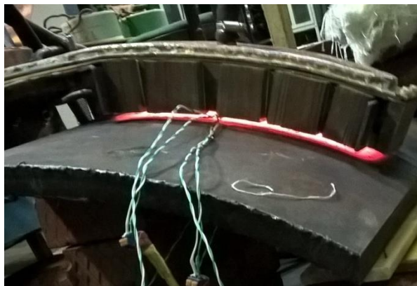
Стенд индукционной термической обработки сварных швов темплетов труб
