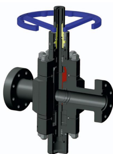
ЗАДВИЖКИ ШИБЕРНЫЕ С БАЛАНСОВЫМ ШТОКОМ DN от 50 до 200 мм , PN от 140 до 1400 кгс/см 2 .
