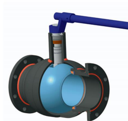
КРАНЫ ШАРОВЫЕ ЦЕЛЬНОСВАРНЫЕ ИЗ ТРЕХ ЧАСТЕЙ DN от 15 до 200 мм, PN от 16 до 40 кгс/см 2 .
