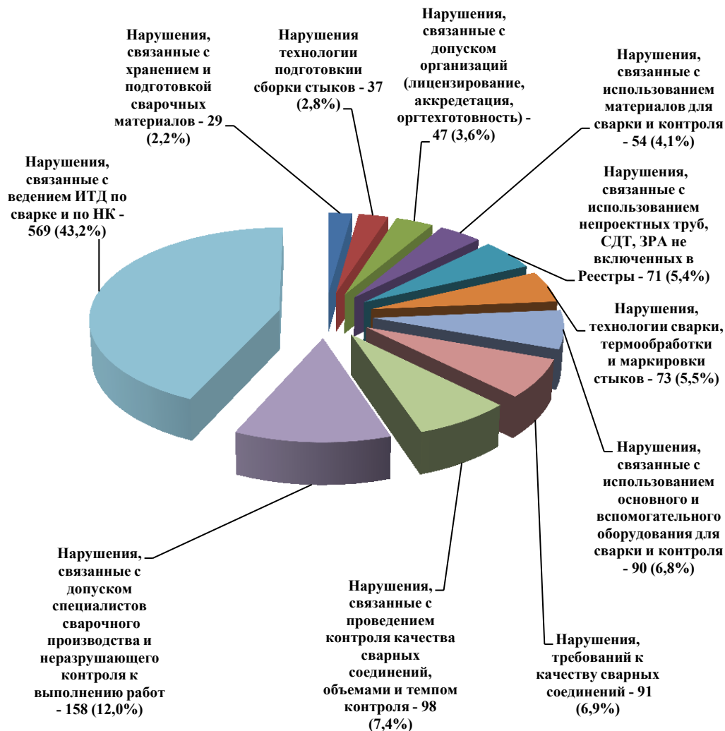
Распределение по видам нарушений, выявленных в III квартале 2016 года
