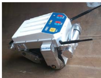
Внутритрубный ультразвуковой сканер-дефектоскоп А 2072 «IntroScan»
