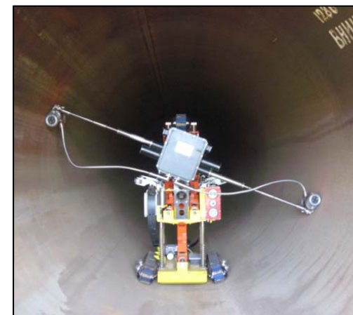
Телеуправляемый диагностический комплекс ТДК-400-М-Л ООО «Газпроект-ДКР»
