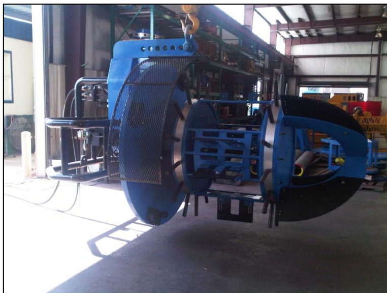
СПК для трубы Ду = 1420 мм Переоснащается для Ду = 1020 , 1067, 1220 мм путем смены секции – экспандера.
