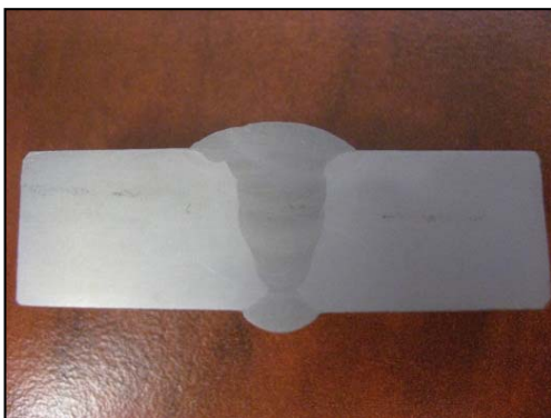
Двухсторонняя Сварка ВЦС + ГАС-2
