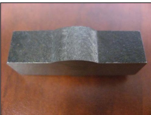
Вид облицовки при использовании функции "Смещение горелок"
