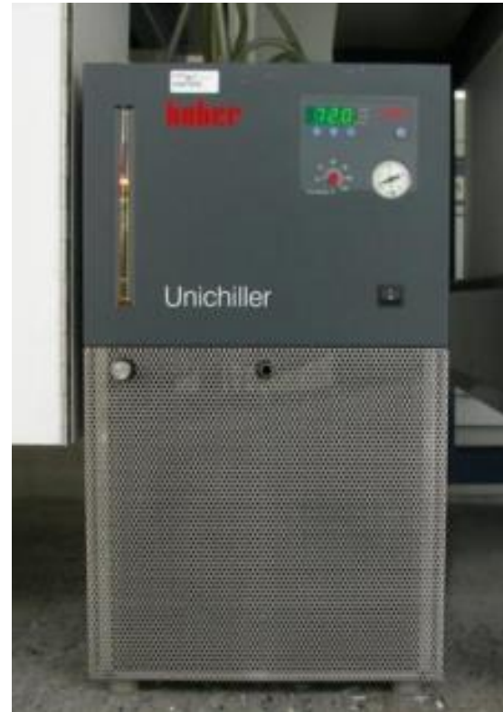
Термостат для охлаждения жидкости до необходимой температуры (н-р, 85 – 95° C)
