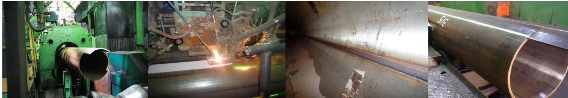
В условиях АО «ВМЗ» на линии производства нефтегазопроводных труб получено автоматической многодуговой сваркой под слоем флюса на биметаллических трубах сварное соединение с высокой стойкостью против межкристаллитной коррозии и требуемыми механическими характеристиками (API Spec 5LD, DEP 31.40.20.32-Gen).
