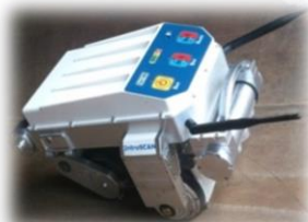
Внутритрубный ультразвуковой сканер-дефектоскоп А 2072 «IntroScan» (ЗАО «ИнтроСкан Технолоджи» г. Чайковский)
