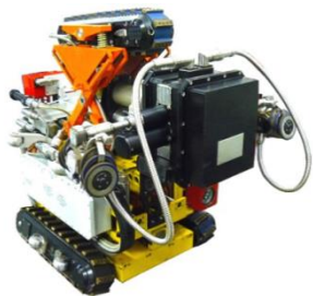
Телеуправляемый диагностический комплекс ТДК-400-М-Л (ООО «Газпроект-ДКР» г. Санкт-Петербург)
