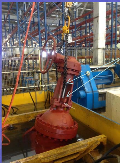
Отсутствие проушин, указателя положения затвора
