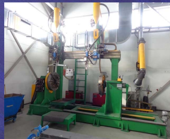
Автоматическая сварка роботизированными комплексами
