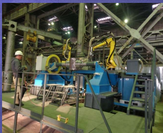
Автоматическая сварка роботизированными комплексами
