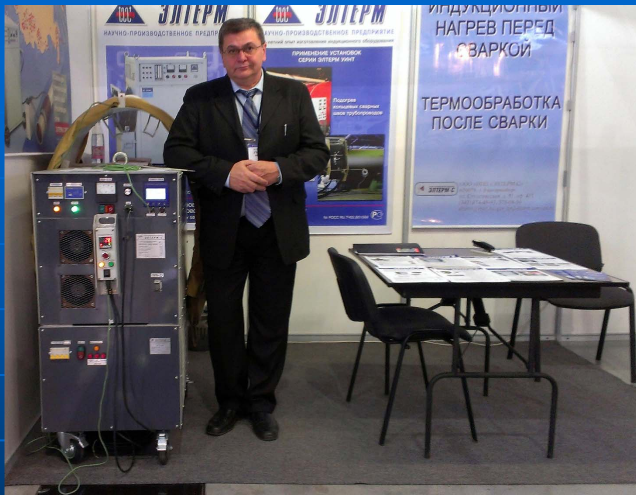
Установка «ЭЛТЕРМ-С УИНТ-30-4,0» совмещенная с автономной воздушной системой охлаждения, пультом управления и блоком автоматики
