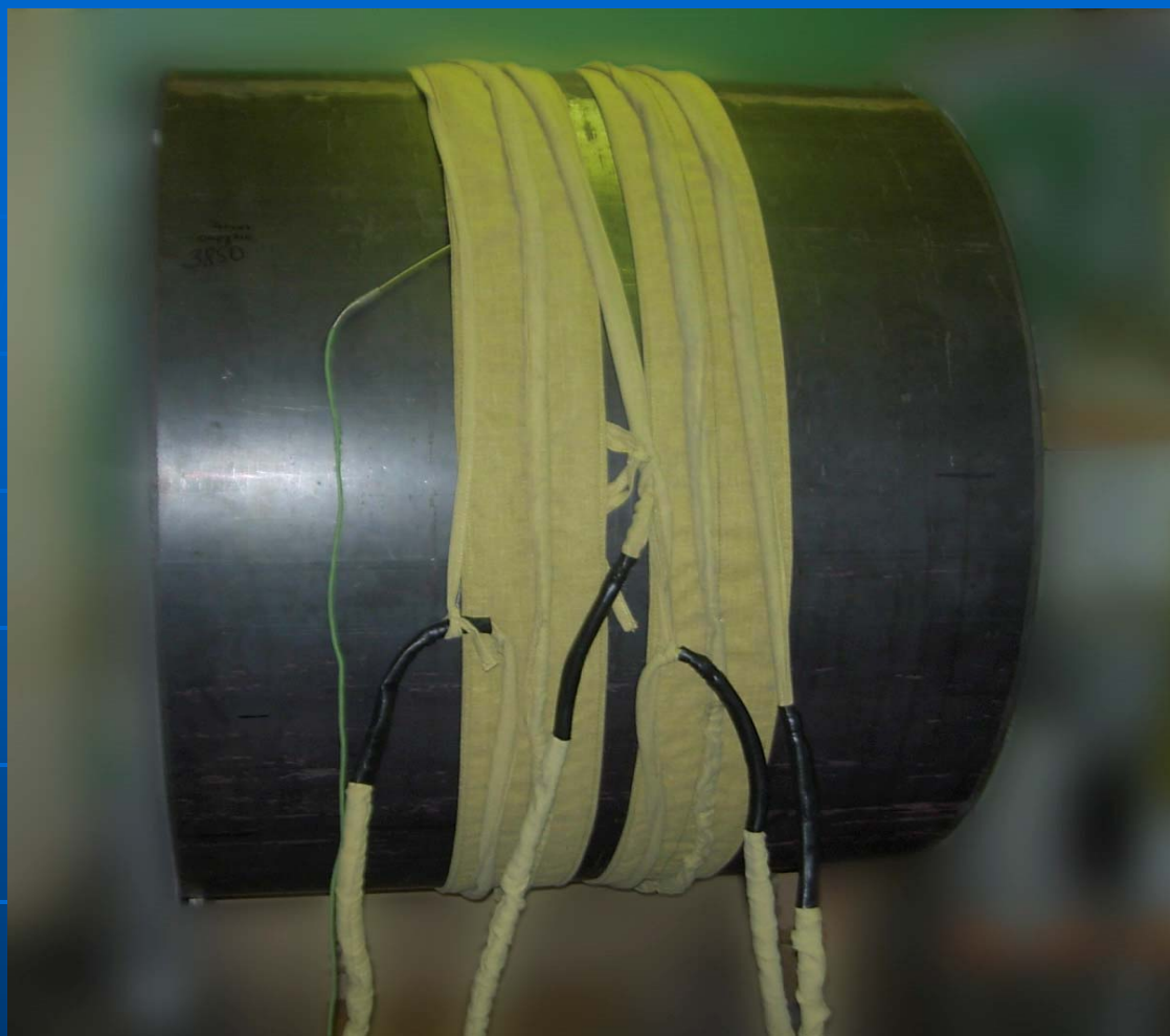
Индуктор – “Абсолютный универсал” (400-1420мм)
