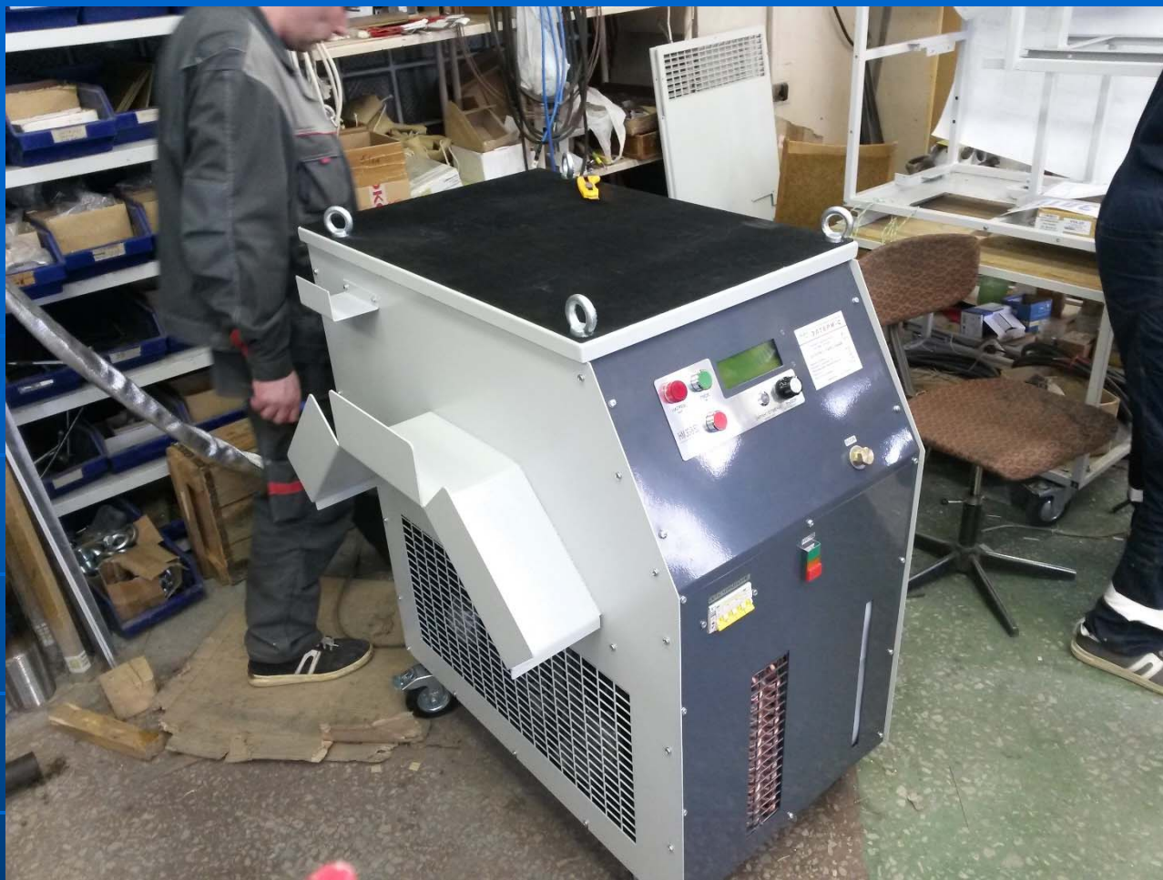
Установка для предварительного и сопутствующего подогрева трубопроводов «ЭЛТЕРМ-С УИНТ-50- 2,4»
