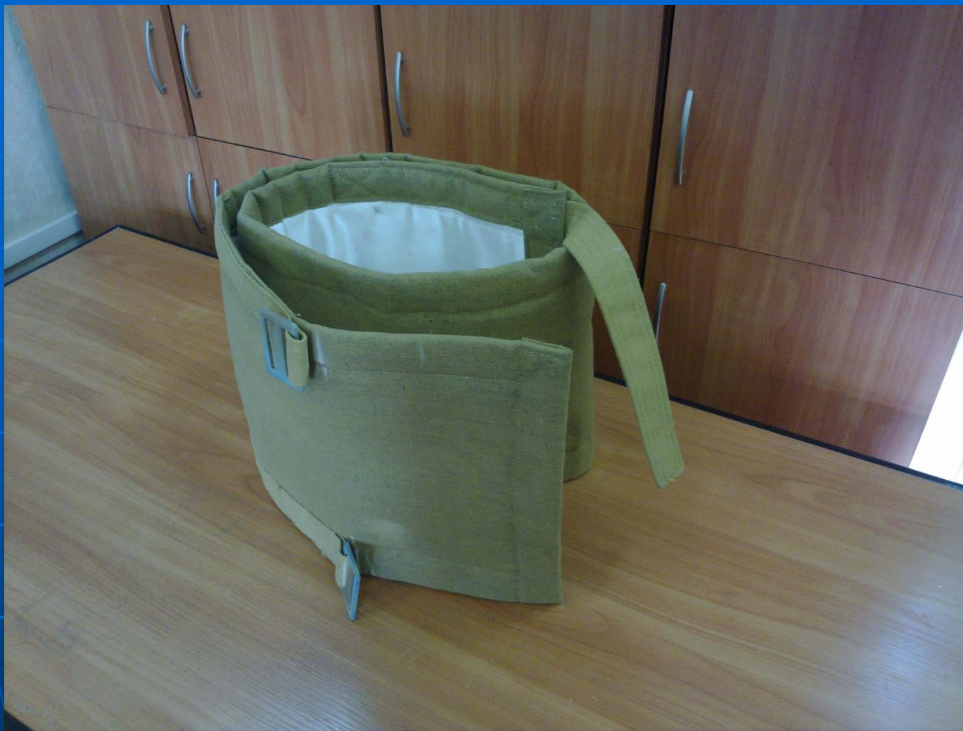
Теплоизоляционный пояс после сварки
