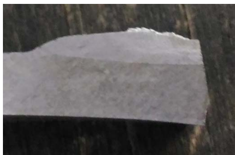
Продольный макрошлиф материал крыльчатки – АК4, присадочная проволока – АК5
