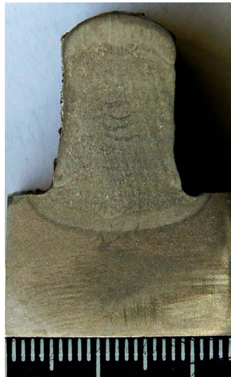
Лазерно-дуговое выращивание: поперечный макрошлиф
