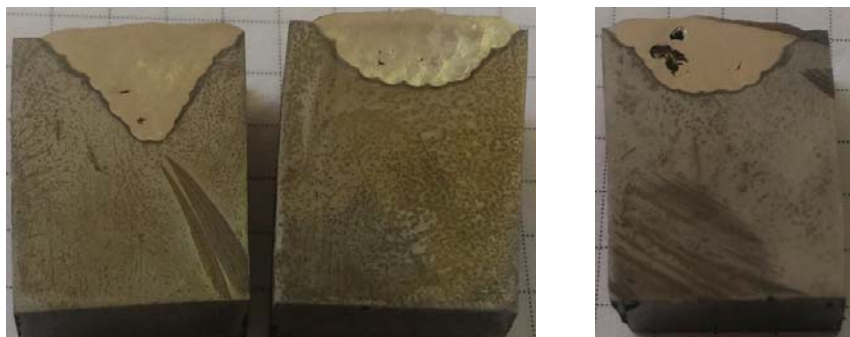
P_{\text{л}}=3\text{кВт} , V=15\text{ мм/с} , D_{\text{п}}=5\text{ мм} , R=2,1\text{ кг/час} ,
