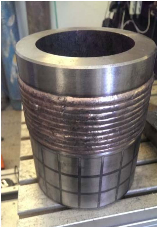
Наплавка уплотняющего пояса из сплава МНЖКТ и нанесение закалочных дорожек на корпус высокоточного боеприпаса
