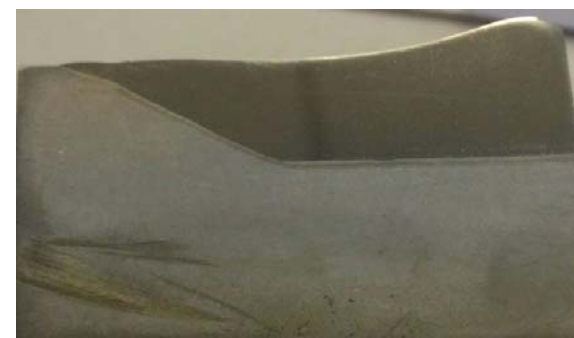
P_{\text{л}}=3\text{кВт} , V=15\text{ мм/с} , D_{\text{п}}=5\text{ мм} , R=1,0\text{ кг/час} , Материал: 4Х5МФС, EuTroLoy 16606A.04
