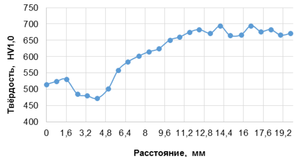
График измерения микротвёрдости по ширине закалённого слоя
