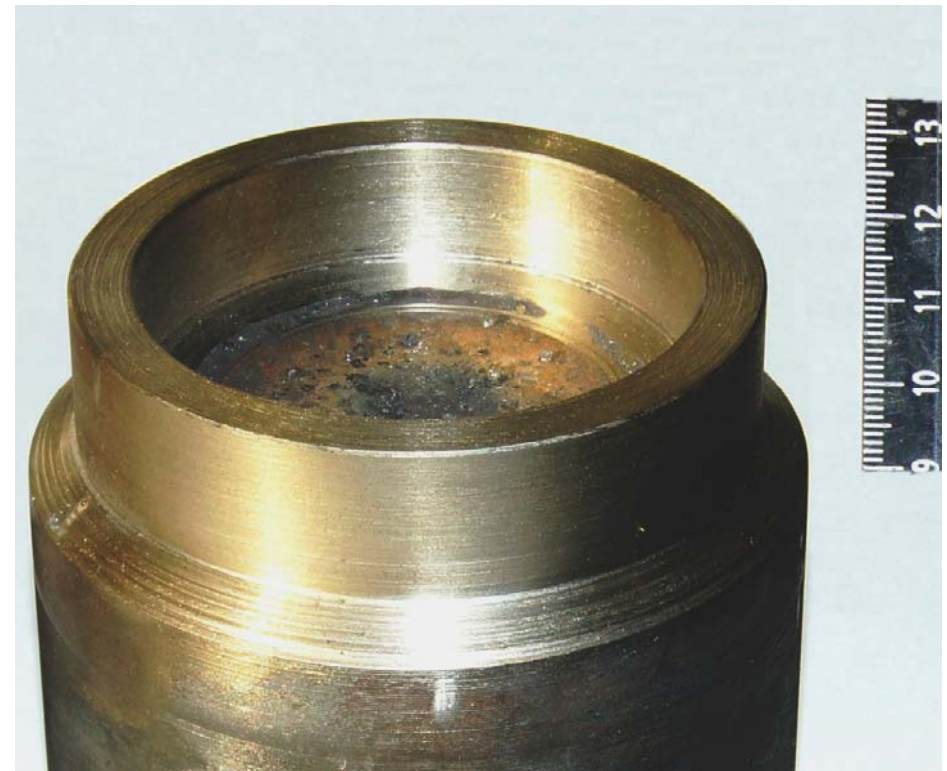
Лазерно-дуговое выращивание: образец после токарной обработки
