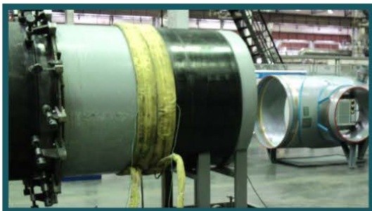
Два индуктора НИГ на трубе диаметром 1420 мм, шириной 160 мм.
