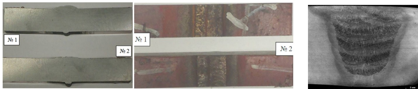
Вид поперечных макрошлифов из КСС № 1 и № 2. Вид сбоку и сверху
