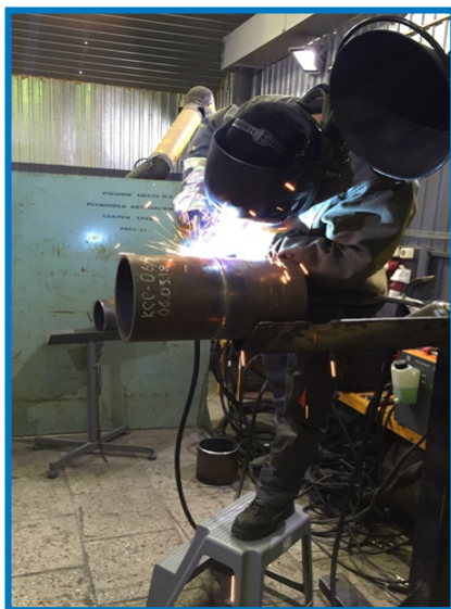
Механизированная сварка порошковой проволокой в среде инертных газов и смесях заполняющих и облицовочного слоёв шва
