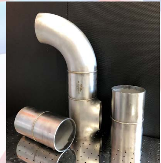
Секции из деталей Ø219×6 мм AISI321
