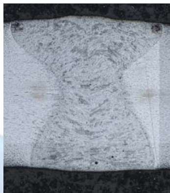
Однопроходная лазерная сварка без присадки
