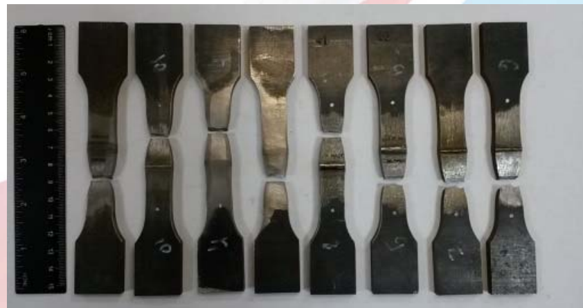
Разрыв образцов по основному металлу
