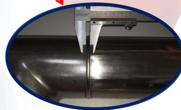
Ширина сварного шва 4 мм
