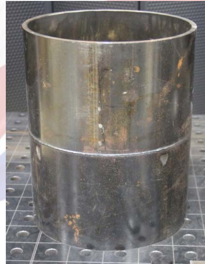
«Труба-Труба» 09Г2С Ø219×6 мм
