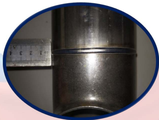
Высота усиления сварного шва 1 мм
