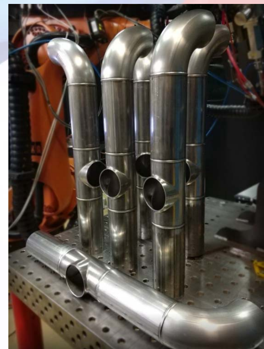
Типовая трубная секция
