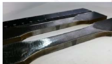
Образцы для испытаний без усиления сварного шва
