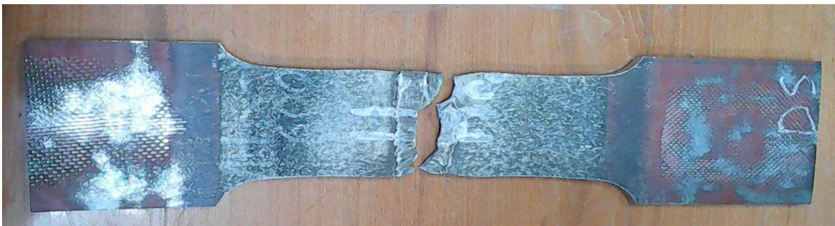
Образец с дефектами в шве
